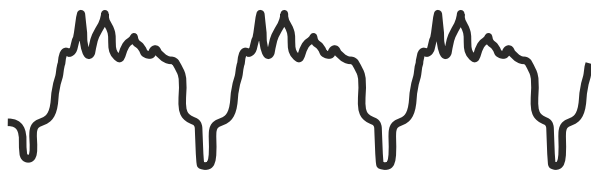
Рисунок 5. Осциллограмма строк ТВ-сигнала.
