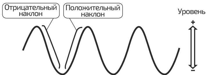
Рисунок 6. Иллюстрация полярности (фронтов) запуска синхронизации.
