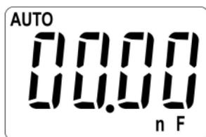
Подключите щупы к обоим концам проверяемого конденсатора. На дисплее будет отображено значение ёмкости конденсатора. Причём если щупы не подключены или ёмкость более 100 мкФ – прибор будет отображать «0,0 нФ». Кроме этого следует отметить, что измерение ёмкости более 1 мкФ – может занять несколько секунд, а ручное переключение диапазонов в этом режиме не предусмотрено.
