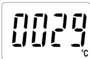
Установите поворотный переключатель в положение « $\Omega-| \rightarrow$  °C °F». Нажмите кнопку «FUNC» 3 раза. Подключите черный штекер датчика в гнездо «COM», а красный штекер в гнездо «V/Ω/Hz». Рабочая часть датчика помещается над или внутри измеряемого объекта, а значение температуры отображается непосредственно на дисплее. Единица измерения – градус Цельсия. Если вам нужно измерять в градусах Фаренгейта, нажмите клавишу «RANGE» для переключения.
